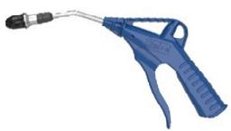
11 208 0952                                | <b>Sicherheits-Blaspistole</b><br>90mm-Rohr, G 1/4" IG,<br>Schalldämpferdüse schwarz nicht abnehmbar,<br>max. Arbeitsdruck 16 bar                                                 | <b>398 l/min</b><br>83,5 dB(A) | Nr. 7248<br>
