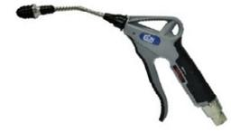
11 210 9952S                               | <b>Sicherheits-Blaspistole Multi-Flow</b><br>90mm Rohr, G 1/4" IG,<br>Schalldämpferdüse schwarz nicht abnehmbar,<br>max. Arbeitsdruck 16 bar                                      | <b>417 l/min</b><br>84,2 dB(A) | Nr. 7158<br>
